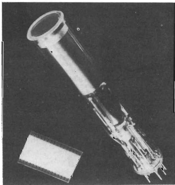
Fig. 2 - Un CCDc sviluppato dalla IBM paragonato ad un comune Vidicon. Il chip misura 25 \times 37,5 mm e contiene 150.000 fotoelementi.
