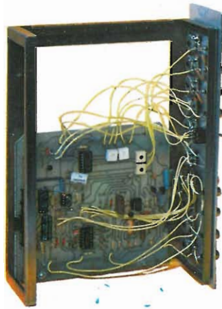
Vista del modulo LFO-NOISE. Si noti la complessa filatura fra basetta e pannello.
